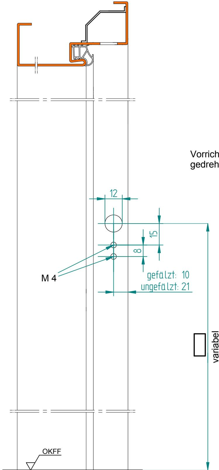
**Ausführung: Zarge vorgerichtet für Montage des Aufnahmekastens**
